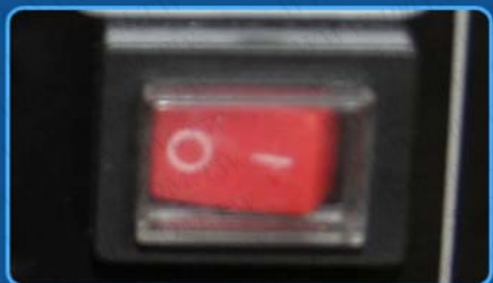
NO6 将熄火开关打到“NO”位置
