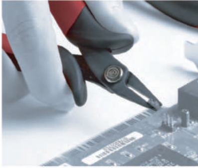
使用德國Wiha 電子尖端鉗夾持小元件和扳彎電線。
