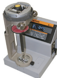
扭力螺丝刀RTD (左)、FTD (右) 的扭力螺丝刀检测仪的校正示例
