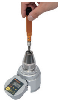
通过小型扭力螺丝刀BMRD的BTGE-G进行扭矩检查的示例
