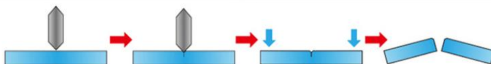
( 正常切割玻璃瓷砖方法，力学参考图 )
