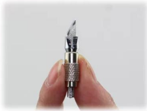
⑤、第五步 套回固定部件，固定住刀片。
