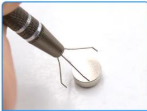
3. 对准将要抓取的小零件
