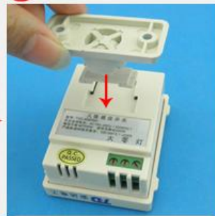
支架放入卡槽
