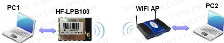
Figure 27. STA 接口连接调试
