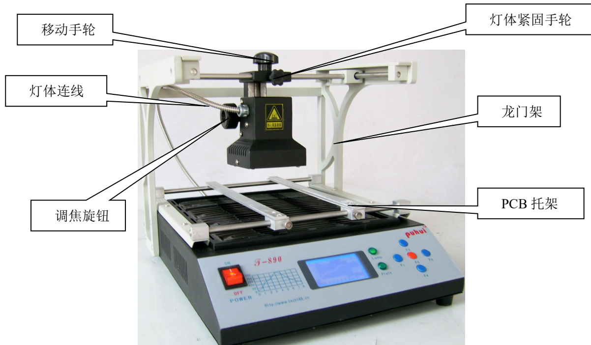
图 4-3：焊台龙门架和灯体
