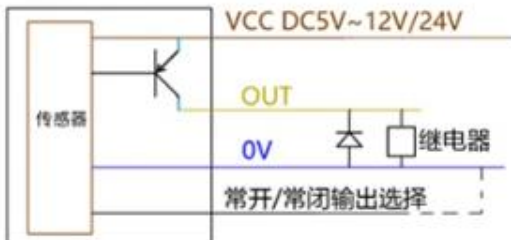
PNP信号输出： 连接继电器的接线方法
