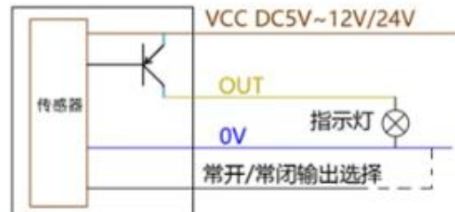
PNP信号输出： 连接指示灯的接线方法
