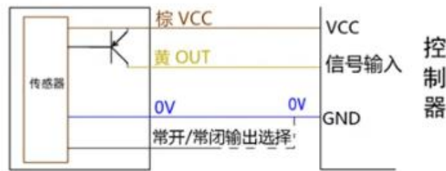
PNP信号输出：连接控制器或MCU的接线方法
