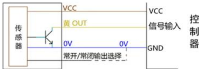
NPN信号输出：连接控制器或MCU的接线方法
