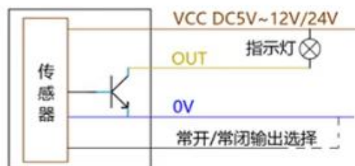
NPN信号输出： 连接指示灯的接线方法
