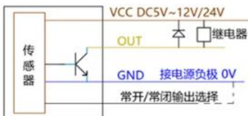
NPN信号输出： 连接继电器的接线方法
