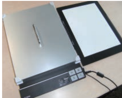
② 在UVSCALE放置在扫描仪上（建议的模式），并对颜色样本进行扫描。
