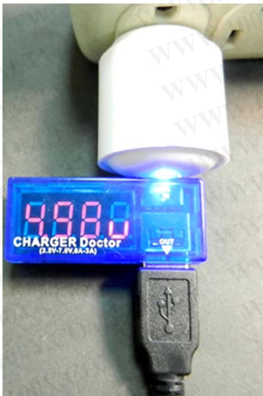
手機連接充電 顯示電壓 5~4.98V
