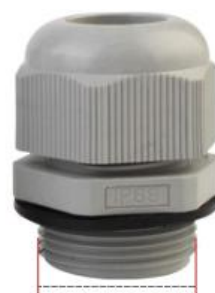
型号: PG29 螺纹外径: 37MM 适用电缆: 13-24MM
