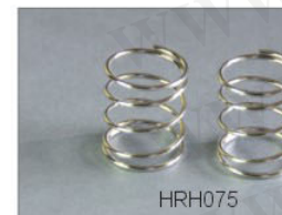
保护板弹簧 (S) \phi 20 \times \phi 1.2 \times 17 \times 5 匝(1.5kg) (L) \phi 20 \times \phi 1.2 \times 24 \times 7 匝(1.2kg) (强) \phi 18 \times \phi 1.6 \times 16 \times 4 匝(7.0kg)
