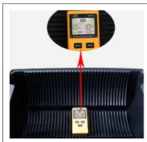
防静电测试 表面的防静电好的效果为 10^6\Omega-10^8\Omega
